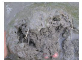
土壌の二重構造（表層がトロトロ、下層がボソボソ）
